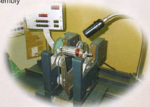
▲ 轉子動平衡測試 Armature Balance Test
