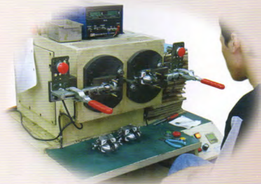
▲ 定子自動繞線 Stator Coil Automatic Winding
